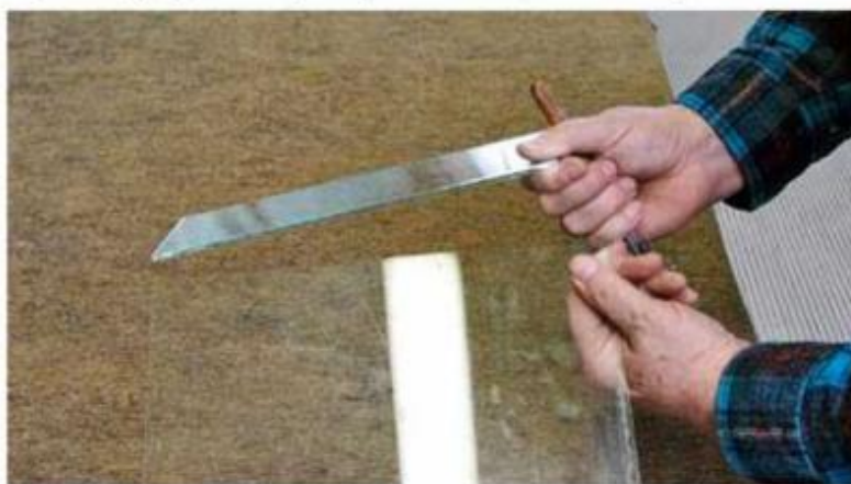
^ Kolečko nasadíte na rysku a vedte plynulý nepřerušovaný pohyb, tlak musí jít ze zápěstí
