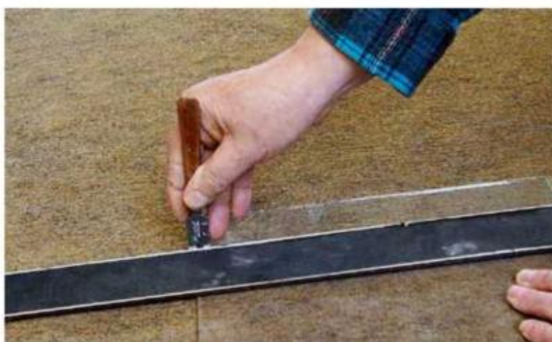
^ Kolečko nasadíte na rysku a vedte plynulý nepřerušovaný pohyb, tlak musí jít ze zápěstí
