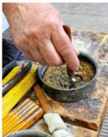
^ Řezací kolečko je třeba namočit do chladící kapaliny, nejlépe do petroleje
